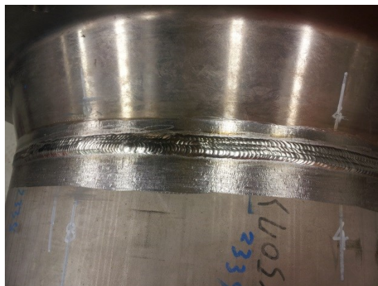
용접 완료 된 티타늄 GTAW 용접 비드
