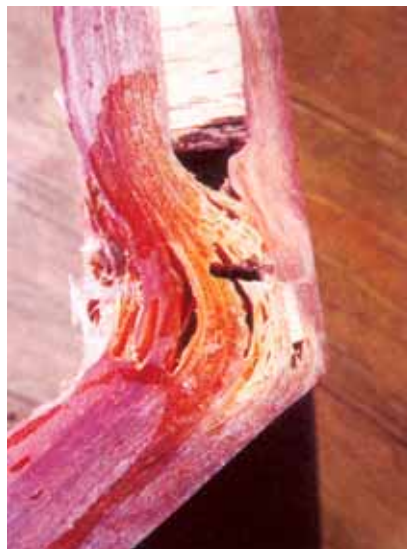
<그림 17> Chine line에서 Balsa의 결함
