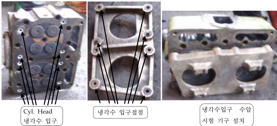
<그림 129> Cylinder Head 하부 냉각수 입구 및 수압시험 장치
