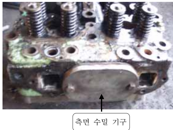
<그림 130> Cylinder Head 측면 냉각수 수밀 기구
